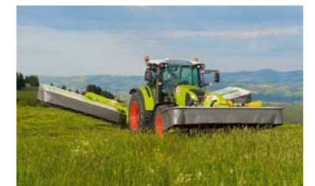
Door de compacte ophanging aan de fronthead beschikt de maaier over veel bodemvrijheid op de kopakker.
