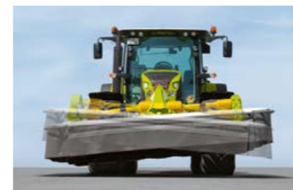
Aanpassing dwars op de rijrichting door de pendelende ophanging.
