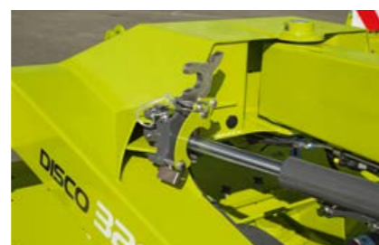
Flexibel: disselverstelling voor snelle aanpassing aan verschillende tractoren zonder gereedschap (optie).
