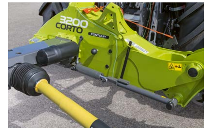
ACTIVE FLOAT cilinder voor de hydraulische ontlasting van de CORTO 3200 CONTOUR.
